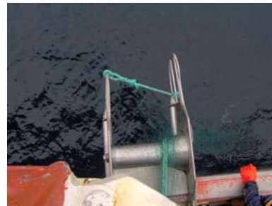
Figure 2 : Guide-filet pour le virage d'un filet maillant.
