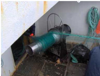
Figure 1 : Tambour ou davier servant à virer le filet maillant.
